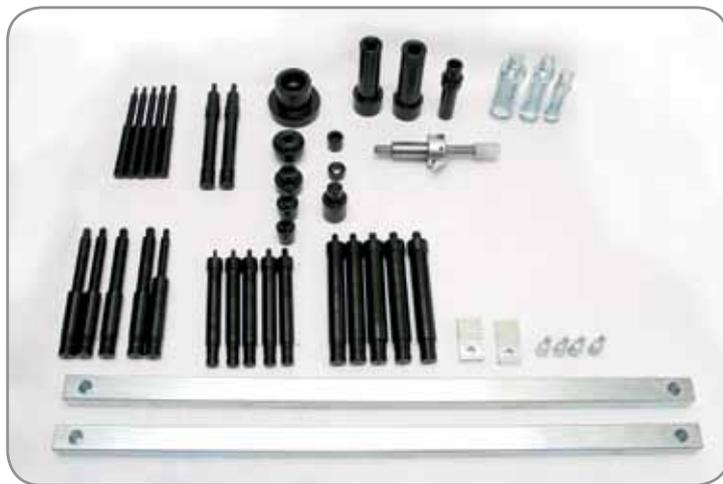
Per rimuovere velocemente, facilmente ed in sicurezza le guide valvole. Riduce l'affaticamento dell'operatore ed il suo costo. La pressa è equipaggiata con un cilindro idraulico di alta potenza. L'equipaggiamento standard include gli attrezzi per smontaggio e montaggio guide, e utensili vari per compressione molle valvole e altre differenti applicazioni.
