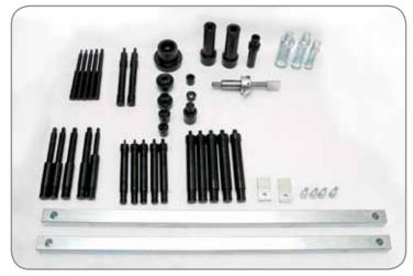
Per rimuovere velocemente, facilmente ed in sicurezza le guide valvole. Riduce l'affaticamento dell'operatore ed il suo costo. La pressa è equipaggiata con un cilindro idraulico di alta potenza. L'equipaggiamento standard include gli attrezzi per smontaggio e montaggio guide, e utensili vari per compressone molle valvole e altre differenti applicazioni.
