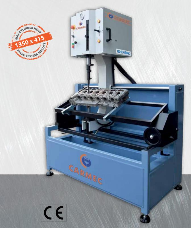
PRESSA IDRAULICA PER SMONTAGGIO E MONTAGGIO GUIDE VALVOLE
