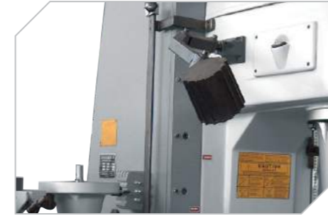
İş aydınlatma lambası ve sınır siviçleri Work lighting lamp and limit switches
