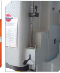
Siviş kutusu; strok ayarının kolay yapılabilmesi için kilepeler yerleştirilmiştir. Swich box; in order to allow practical stroke adjustment wing screws are placed.
