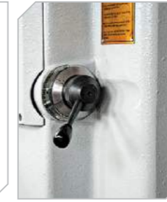
152104 Hidrolik hız ayar ünitesi iş esnasında honlama strok hızını ayarlamana sağlar. Hydraulic speed adjustment unit allows you to adjust honing stroke speed during the work.
