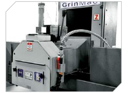
Kafa üzeri taş bileme aparatı Wheel dressing apparatus on cutting head
