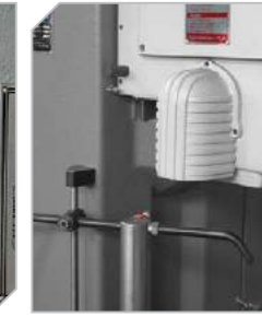
İş aydınlatma lambası şanzıman hareket sınır sivişleri Work lighten lamp and transmission movement limitation switches.
