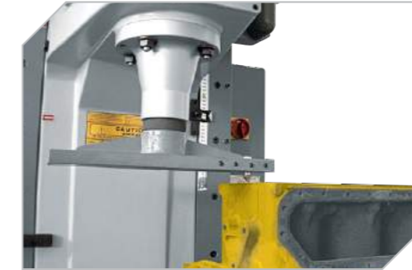
Motor bloğu yüzey tarama başlığı Engine blocks surfacing head
