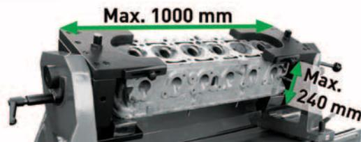
• Sistema di fissaggio delle testate che combina un sistema regolabile di fissaggio laterale universale con la possibilità di ruotare la testa 130° per adattare all'inclinazione delle guide, inclusi supporti inferiori, braccetti orientabili, blocchetti a T, e fissaggi regolabili
