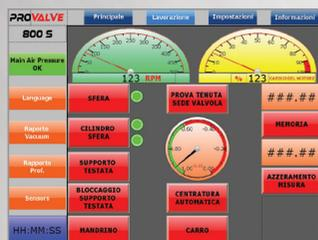
a) Blocco/sblocco del cuscino d'aria della sfera e cilindro sfera mediante pulsante touch
